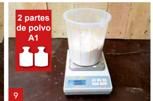
9 Pese 2 partes de polvo A1. En este ejemplo utilizamos 1000 g de Polvo A1.
