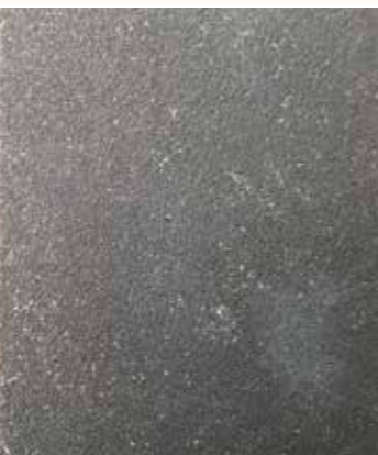
Panel A1 con arena después de 5 años de exposición a la intemperie.
