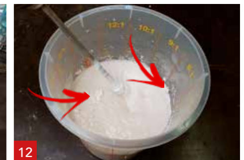
12 Remueva el mezclador hasta que todos los grumos hayan desaparecido (± 1 min.) obteniendo un material suave.
