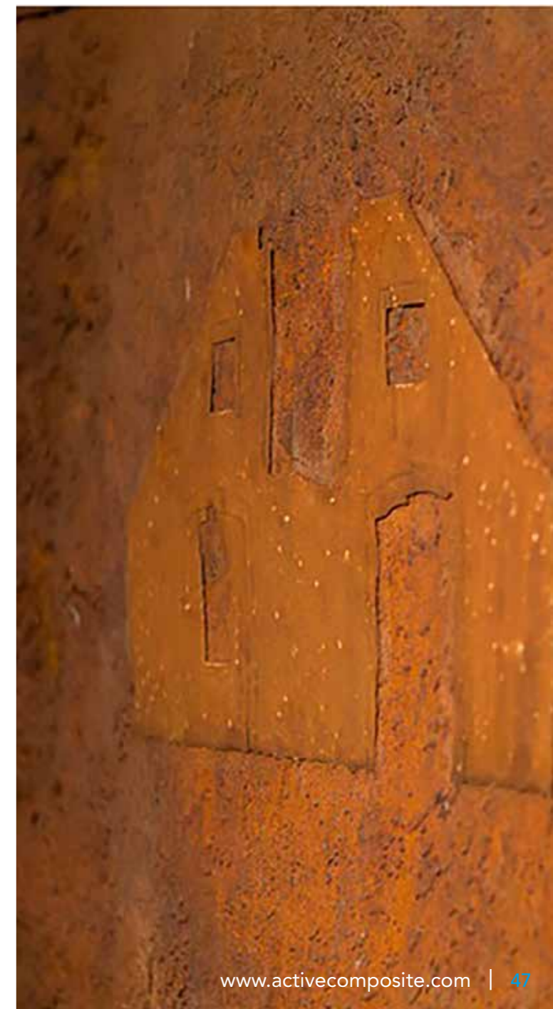
Después de la exposición al agua, el polvo de hierro mezclado en el A1 da hermosos efectos naturales y únicos de óxido.
