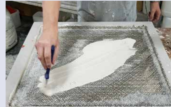
Para laminar, hay que trabajar en húmedo. Una forma rápida de aplicar el A1 es con una brocha o un rodillo.
