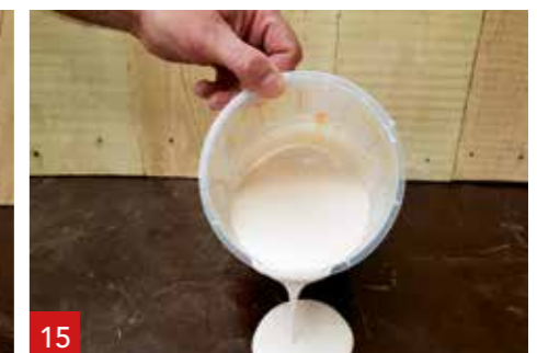
15 A1 está listo para laminar, colar o pulverizar. Tiempo de procesado 20 - 25 minutos.
