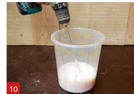
10 Ponga el mezclador (pincho) en el vaso de líquido A1 y cree un remolino.
