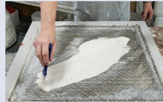
Wanneer je lamineert, werk je nat in nat. Een snelle manier om de A1 aan te brengen is met een kwast of roller.
