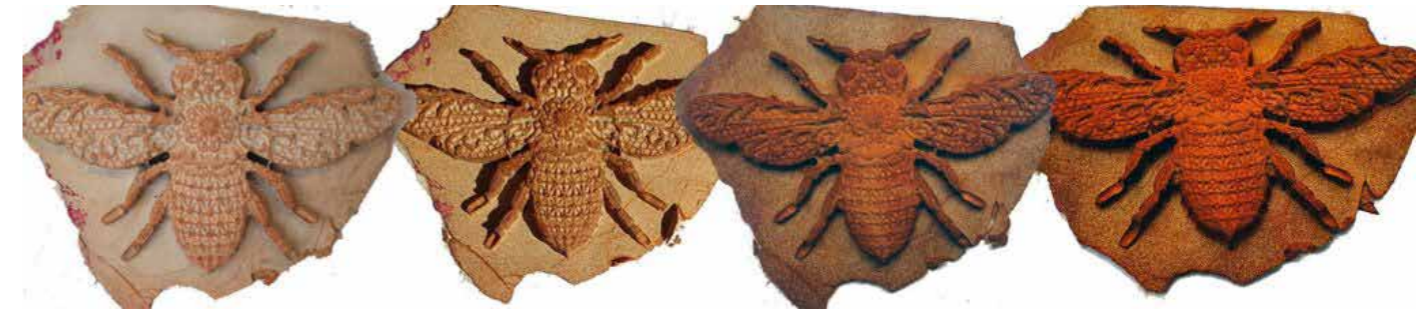
Na blootstelling aan water toont het in de A1 gemengde ijzerpoeder prachtige natuurlijke en unieke roesteffecten.
