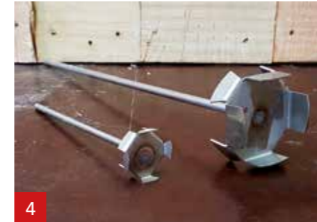
4 Gebruik de A1 mixer. Klein: tot 1,5 kg A1. Groot: 1,5 kg of meer A1.
