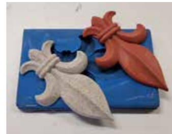
Resultaat na drogen en verwijderen: een massief gietobject, een exacte kopie van de mal.
