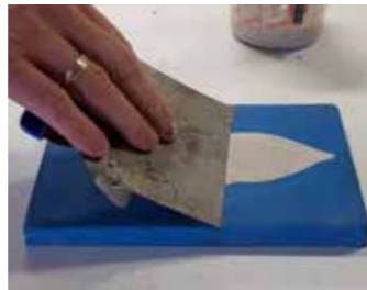
Giet de gewenste hoeveelheid A1 in de mal en schraap de overtollige A1 weg met een plamuurmes.
