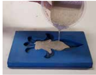
Gießen Sie einen Teil der A1 Masse in die Form. Sofern möglich, bürsten Sie die Form zunächst aus, damit alle Aussparungen/Strukturen von der A1 Masse ausgefüllt werden.
