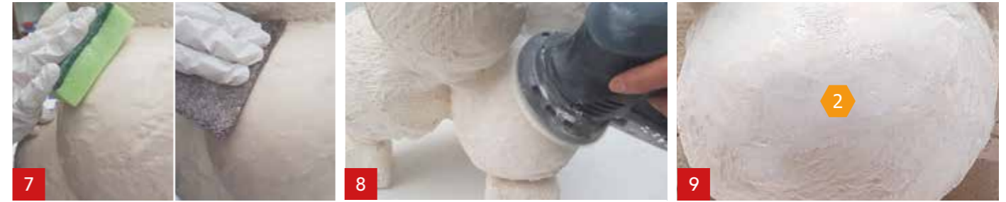
Sie können die Oberfläche (nach ±20 Minuten) auch mit einem feuchten Schwamm oder mit wasserfestem Sandpapier bearbeiten.
