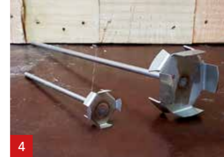
4 Verwenden Sie einen A1 Mischstab. Klein: bis zu 1,5 kg A1. Groß: 1,5 kg A1 oder mehr.
