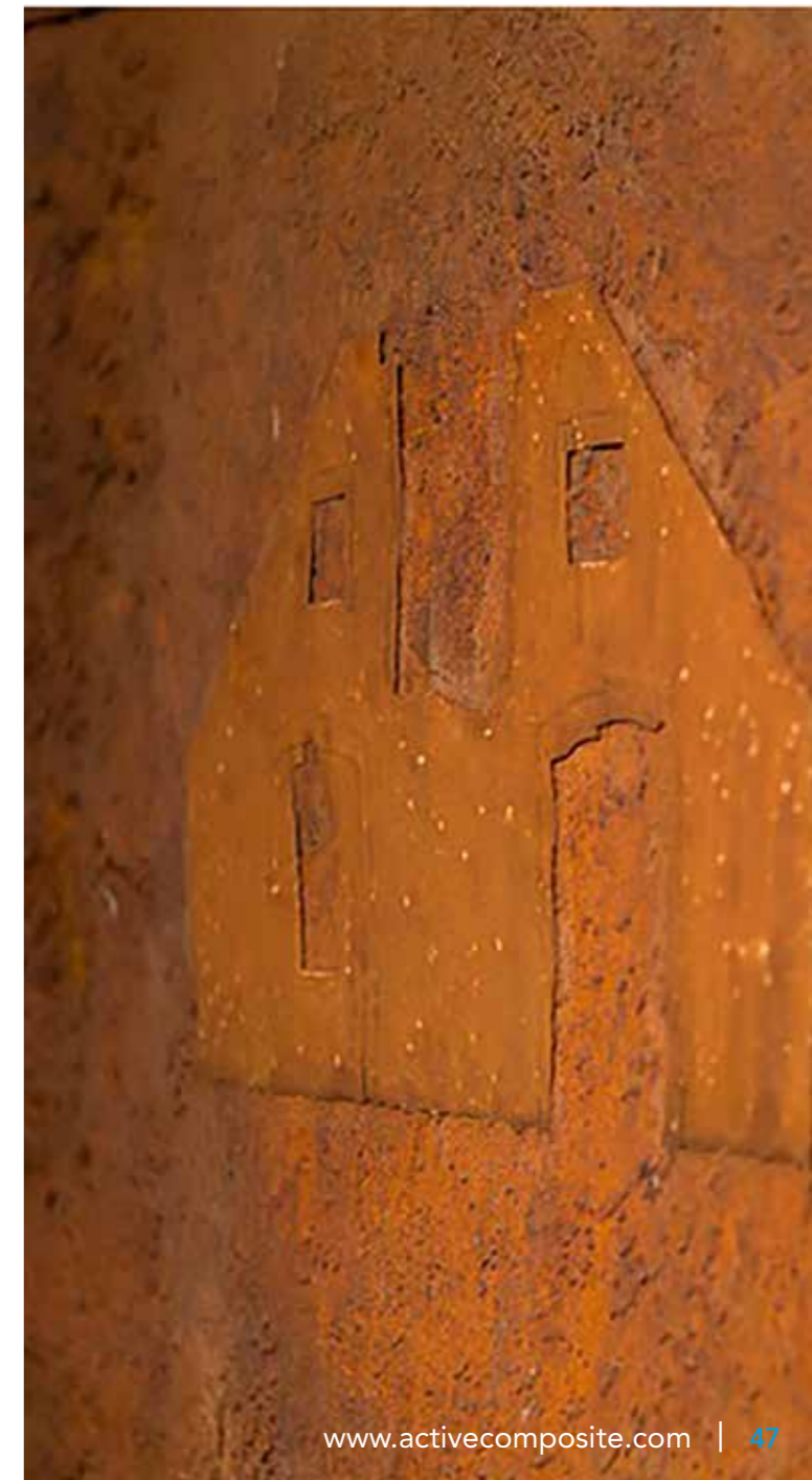
Nach dem Kontakt des Gemisches aus Eisenpulver und A1 mit Wasser entstehen wunderschöne, natürliche und einzigartige Rosteffekte.
