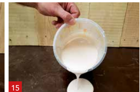
15 Die A1 Mischung kann laminiert, vergossen oder versprüht werden. Die Verarbeitungsdauer beträgt 20-25 Minuten.
