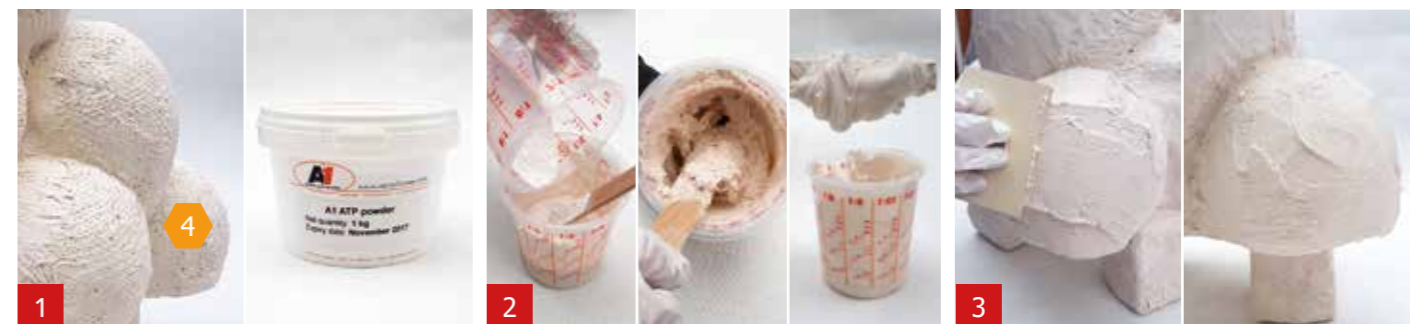
Für eine glatte Oberfläche: Wiegen Sie 1 Teil A1 Flüssigkeit und 2 Teile A1 Pulver ab und vermischen Sie beides, bis keine Klumpen mehr vorhanden sind. Stellen Sie das ATP Pulver bereit.
