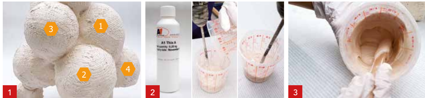
Für eine glatte Oberfläche: Wiegen Sie zunächst 1 Teil A1 Flüssigkeit und 2 Teile A1 Pulver ab.
