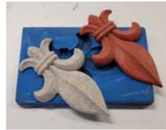
Ergebnisse nach dem Trocknen und Entformen: ein festes Gussobjekt, eine exakte Kopie des Originals.
