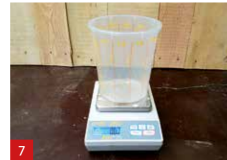
7 Stellen Sie einen leeren Behälter auf die Waage. Trieren Sie die Waage mit dem Behälter (0,0 g).
