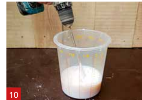
10 Halten Sie den Mischer in den Behälter mit der A1 Flüssigkeit und erzeugen Sie einen Strudel.
