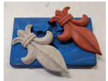
Wynik po wyschnięciu i wyjęciu; utwardzony odlany obiekt, dokładna kopia formy.
