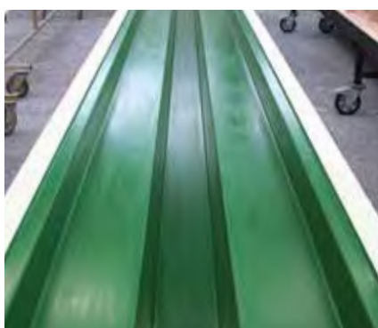
Poliestr wzmocniony włóknem szklanym
