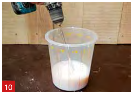
10 Włóż mieszadło (pod kątem) do pojemnika z płynem A1 i mieszaj tak, aby powstał wir.
