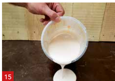
15 A1 jest gotowy do laminowania, odlewania lub natrykiwania. Czas obróbki wynosi 20-25 minut.
