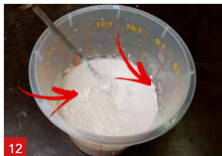
12 Mieszaj mieszadłem, aż znikną wszystkie grudki ( \pm 1 min.) uzyskując gładki materiał.
