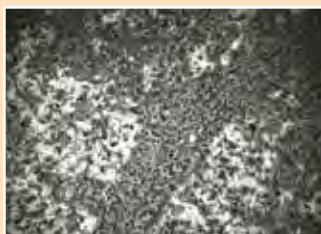
Powiększone zdjęcie paneli A1 z A1 Sealer po 4 latach po słonecznej stronie.
