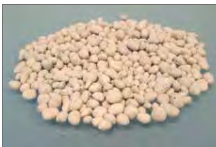
Wypełniacz szklany Poraver - nie do użytku zewnętrznego
