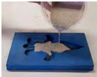
Wlej część przygotowanego A1 do formy. Zacznij (jeśli to możliwe) od nałożenia pędzlem warstwy na formę, aby wszystkie nierówności/ubytki zostały pokryte A1.
