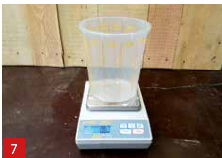
7 Umieść pojemnik na wadze. Wytaruj wagę razem z pojemnikiem (0,0 g).
