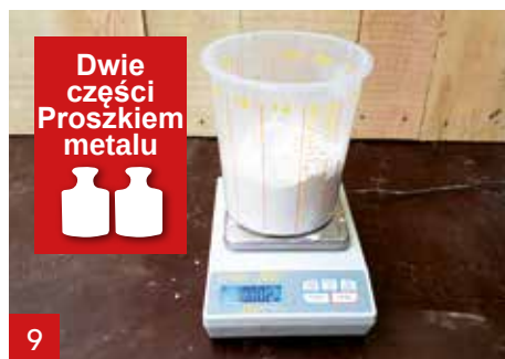
9 Zważ dwie części proszku A1. W tym przykładzie stosujemy 1000 g proszku A1.
